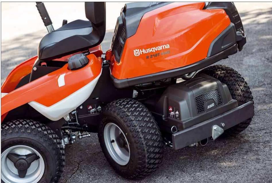
Die Knicklenkung des Husqvarna passt gut zur Wildkrautbürste, denn damit wird die Maschine enorm wendig
