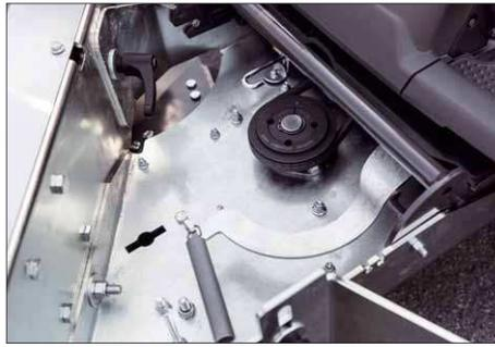
Die Kraftübertragung vom Mäher auf die Maschine erfolgt mit einem Keilriemen, der im Betrieb natürlich unter einer Abdeckung läuft
