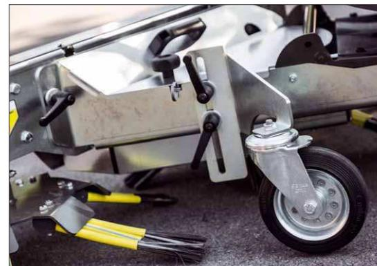
Verschleiß der Drahtbündel kann mit der Höheneinstellung des Stützrads ausgeglichen werden
