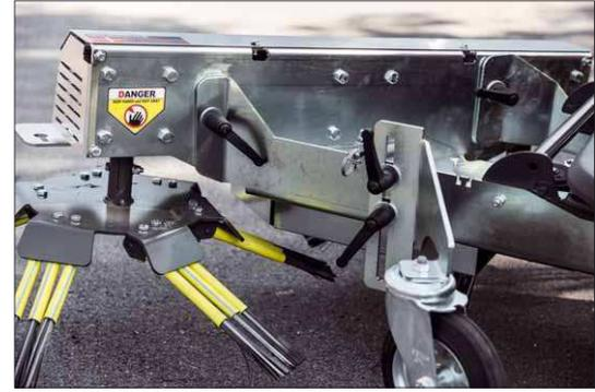
Diverse Einstellmöglichkeiten machen die Nutzung auf beinahe jedem Pflaster möglich. Bei geeigneten Flächen kann die Bürste mit zwei Knebelschrauben sogar schräg gestellt werden
