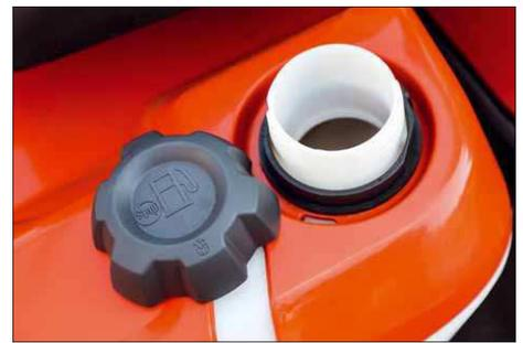
Der große Tank-Einfüllstutzen ermöglicht einfaches Nachtanken aus dem Kanister, ohne zu kleckern
