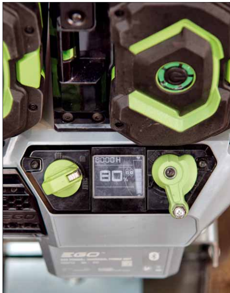
Das Display informiert über die Betriebsstunden, sowie den Ladestand der Akkus
