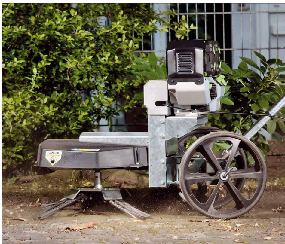
Der Bürstenkopf kann um 15° nach rechts oder links geschwenkt werden. das erleichtert randnahes Arbeiten z.B. im Bereich von Mauern oder Wänden
