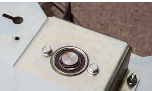
Auch an der Oberseite sind alle Lager gut gegen Schmutz geschützt. Das ganze Gerät ist zudem stabil verarbeitet
